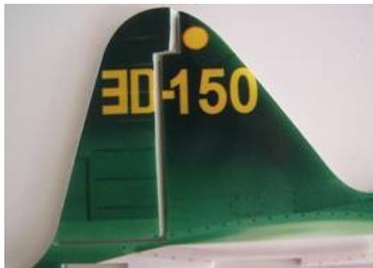
Bei einem scharfen Messer erhält man einen sauberen Schnitt im 60° Winkel an allen Teilen wie ersichtlich.
