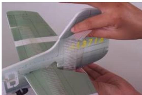
Nun das Höhenleitwerk einbringen und mit dem Rumpf mit Styroschnellkleber verbinden.
