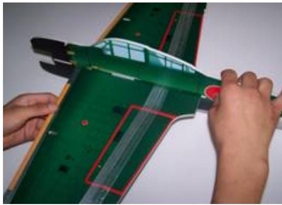
Bitte zunächst die senkrechten Teile von oben und unten in die vorgesehenen Löcher in der Tragfläche mit Styroschnellkleber anbringen und mit Aktivator "nachsprayen ..." dann hält es direkt! Darauf achten das Sie die Teile im 90° Winkel zur Fläche verkleben!
