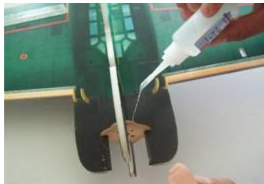
Bringen Sie den Motorspant wie abgebildet ein... wenn er ein wenig fest sitzt NICHT mit dem Messer nachschneiden, sondern "behutsam" mit der Hand ein wenig Druck ausüben, bis er fest in der Verankerung sitzt! Danach mit Kleber fixieren!
