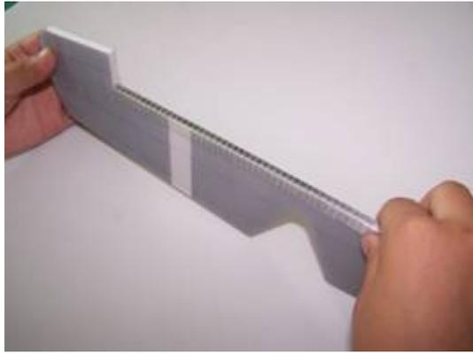
Nun die Höhen- und Seitenruder genau so zunächst mit dem Kohlestab beplanken und dann mit Gfk Band verbinden wie bei den Querrudern bereits beschrieben!
